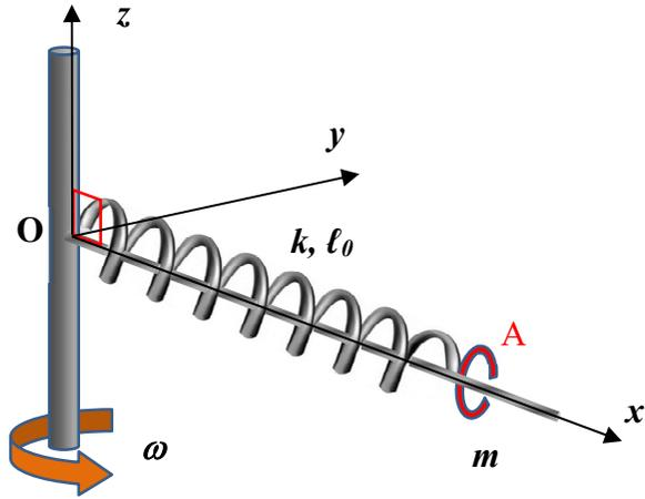
La tige tourne dans un plan *horizontal* à vitesse angulaire constante  $\omega$ . Le schéma ci-dessus est en perspective : la tige est orthogonale à l'axe vertical, elle est donc bien horizontale. L'anneau A coulisse sans frottement sur la tige.
