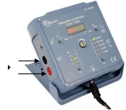
Observer à l'oscilloscope le signal du GBF et le signal délivré par les 2 bornes du bas à droite.
