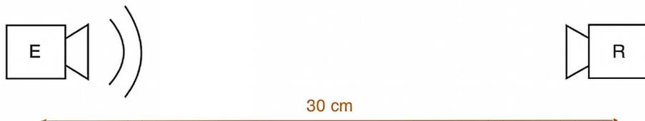
Régler l'orientation du cornet du récepteur à 0°. Réaliser les branchements nécessaires (ci-contre). Positionner la console sur le mode "créneau".
