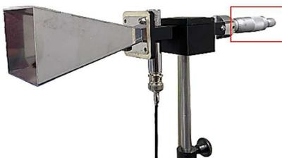
On cherche la fréquence de résonance du système, c'est-à-dire la fréquence pour laquelle le signal du récepteur est le plus fort.
