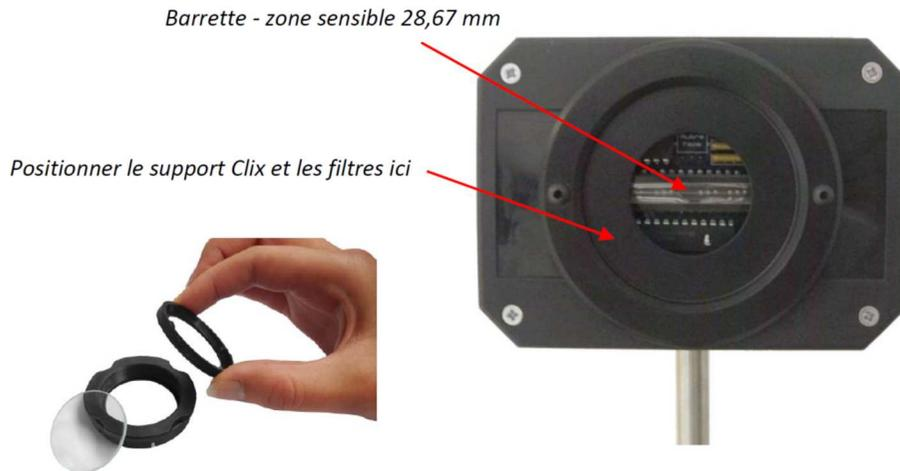
La barrette est naturellement très sensible. Pour utiliser le capteur avec des sources assez intenses, il est nécessaire d'atténuer la lumière lui parvenant. Pour cela, la monture Clix permet de recevoir soit le filtre gris de densité 3, soit le filtre polarisant (lorsque l'ont fait tourner la monture, on peut ainsi atténuer la plupart des lasers qui sont polarisés linéairement), soit les 2 superposés.
