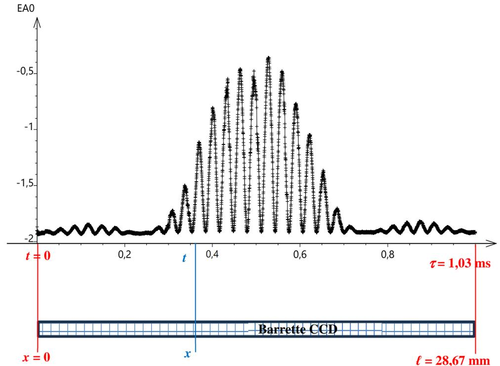
Le signal obtenu en EA0 est la tension  $u(t)$  relevée de pixel en pixel au cours du temps. Le schéma ci-dessus permet d'établir la relation entre le temps  $t$  (mesuré sur l'enregistrement), les caractéristiques  $\tau$  et  $\ell$  de la barrette et la distance  $x$  cherchée.
