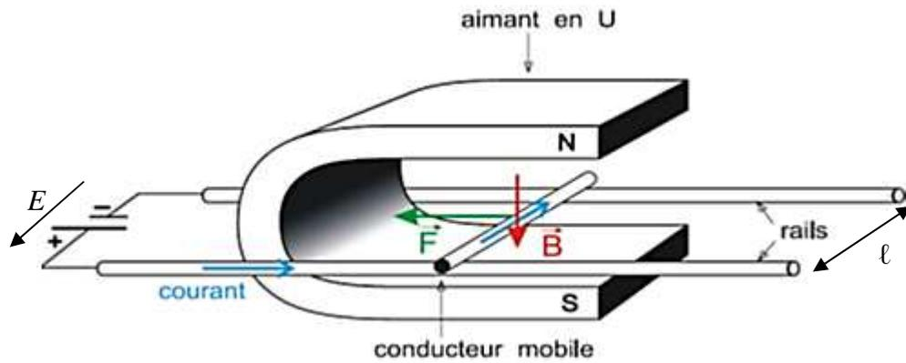
Le circuit, placé dans un champ  $\vec{B}$  uniforme et constant, est parcouru par un courant d'intensité  $i(t)$  (la d.d.p.  $E$  appliquée entre les rails est constante).
