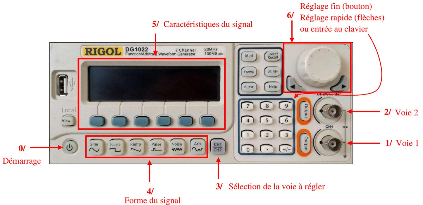
**0. Démarrage** (attention, il existe un interrupteur à l'arrière du GBF !) Attendre la fin du processus et un affichage de la forme :
