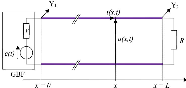
La longueur du câble est  $L = 100$  m. Mesures au RLC-mètre : inductance =  $20 \mu\text{H}$  pour 100 m et capacité =  $10 \text{nF}$  pour 100 m.
